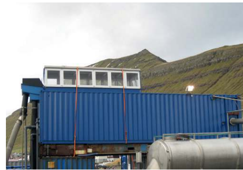
Den mobile aflivningsenhed er indrettet i en container, som kan flyttes fra skib til skib og sejles ud til opdrætsstedet.
